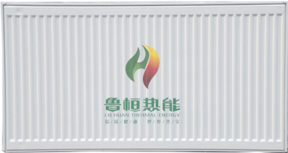
如何正确选购暖气片那?好选择大品牌的产品，因为好的暖气片标志非常齐全，标签上都会详细标注暖气片的单位重量、散热量、承受的压力、供暖面积等。另外需要检查暖气片焊点质量如何，用手触摸表面判断其是否光滑。掂量暖气片的重量，这是判断暖气片板材厚度是否达标、生产商是否偷工减料的简单办法。暖气片一半热一半不热，大多数是因为暖气片内存在空气而没有放气引起的：在供暖打压的时候，供暖系统的管道和暖气片内积存了大量残留的空气，形成了热水循环不畅的状况，进而使得暖气片呈现不热的现象。所以在暖气片的上方安装放气阀，用于放走气体，使暖气系统循环通畅。目前市场上有手动放气阀与自动放气阀两种。手动放气阀放气的方法：手动放气阀上面有一道杠杠，侧面有一个很小的小孔，用平口螺丝刀把那道杠杠扭动一下，这样小孔就对齐了放气口开始放气，一直放到出水后就可以关闭放气阀了。
